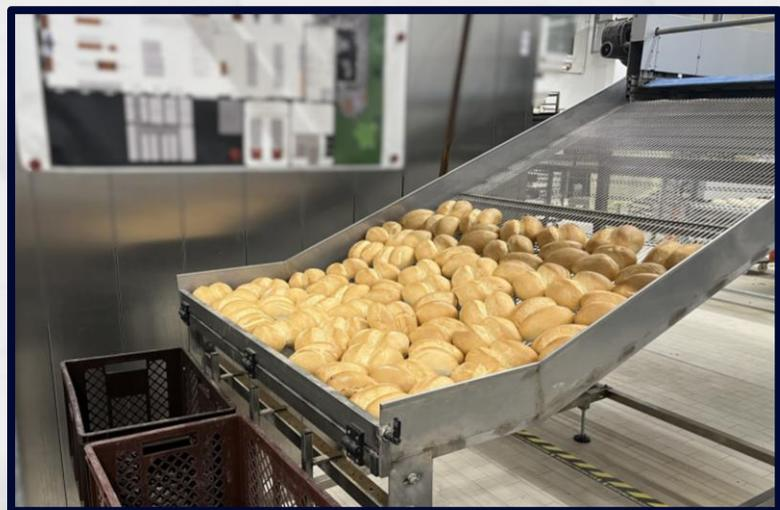
**Die Abgaberutsche aus Edelstahl erleichtert das Entladen des Beladers und den anschließenden Verpackungsvorgang**
